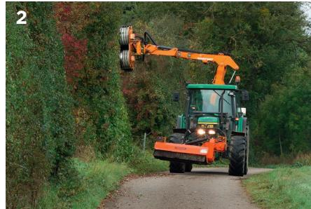
Der Schneidkopf (Skorpion) wird an einen Traktor angebaut und kann drei Arbeitsgänge gleichzeitig erledigen: Schnitt, Häckseln, Räumen. /
