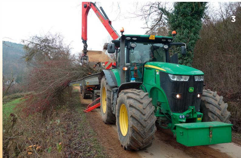
Häckseln des Schnittguts. Dieses wird später als Mulchmaterial eingesetzt oder thermisch verwertet. /
